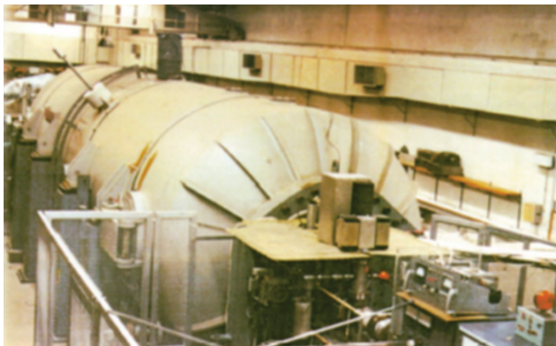
איור 5: מתקן ה-FEL הראשון במכון ויצמן שנבנה על ידי קונסורציום ה-FEL אחרי המרת מאיץ יונים אלקטרוסטטי (TANDEM van der Graaff) למאיץ אלקטרוניים. לזירה ראשונה בגלים מילימטריים הודגמה בחנוכה 1997.
