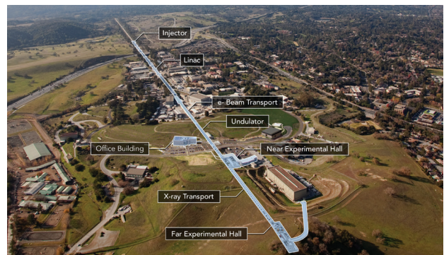
איור 3: X-Ray FEL הראשון בעולם (SLAC-LCLS). לזר בפעם הראשונה ב־10 באפריל 2009 בתחום אורכי גל 15-1.5 Angstrom. ה־FEL מבוסס על מאיץ LINAC בעל אנרגיית האצה 13.6 גיגה-וולט באורך קילומטר ו־wiggler (undulator) באורך 112 מטרים.
