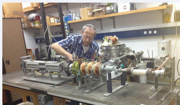
איור 4: מערכת ניסוי Free Electron Maser (FEM) באוניברסיטת תל אביב. הצילום מראה את המערכת בשלב שבו מהנדס המעבדה חיים קליינמן מפרק את המתקן לקראת העברתו לאריאל. המתקן מוצב ביום במרכז המבקרים בכניסה למרכז המאצים באריאל, ומשמש להדגמת עקרונות הפעולה של Superradiant FEL.
